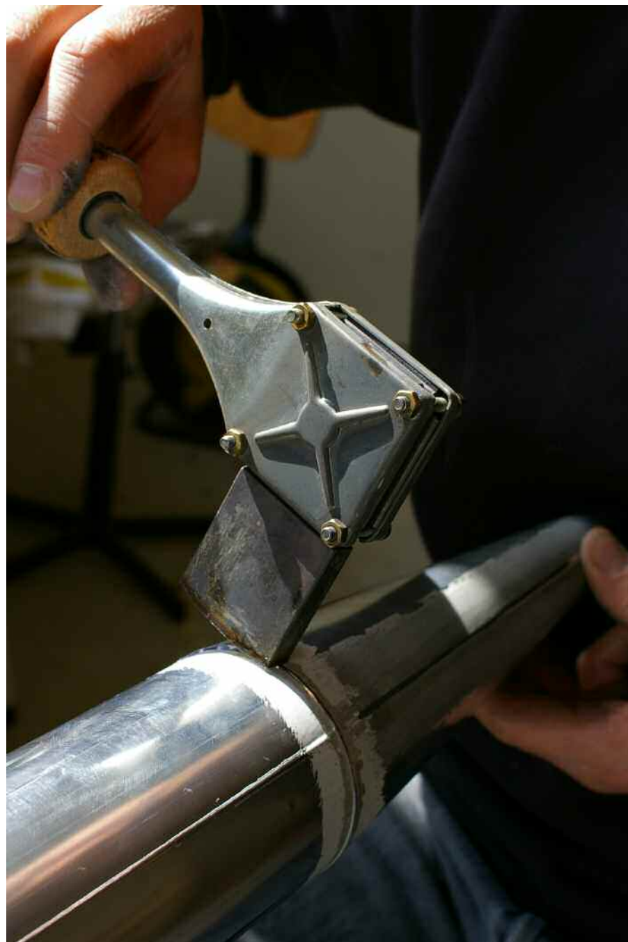
SOUDURE DU PIED ET DU CORPS
