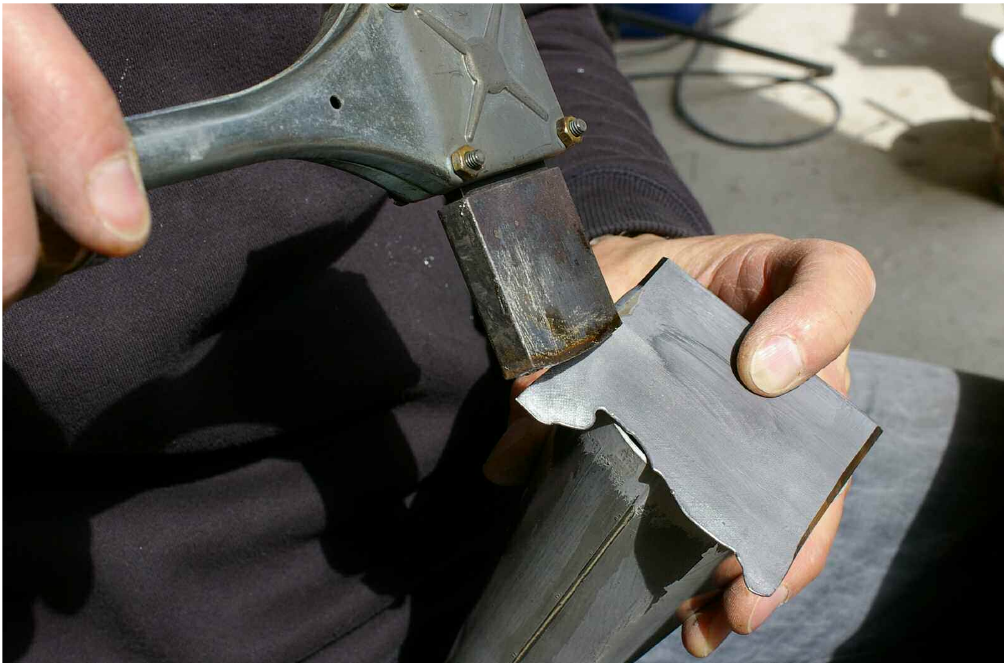
POINTS DE SOUDURE DU BISEAU SUR LE PIED
