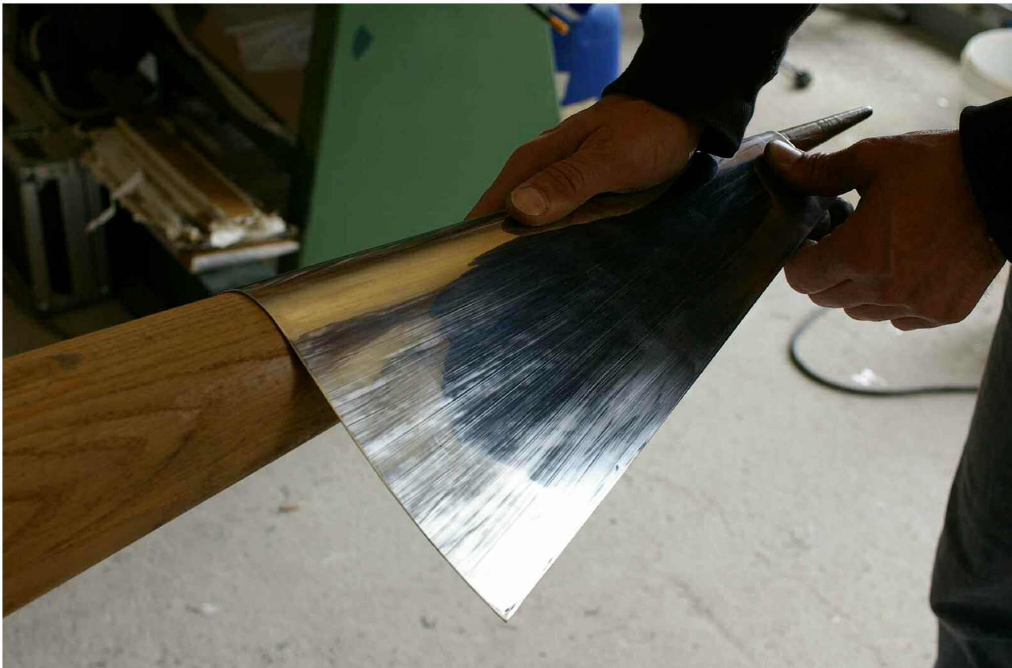
MISE EN FORME DU PIÉD
